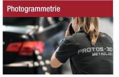
Mithilfe des TRITOP KMG-Systems, einer portablen, optischen 3D-Koordinatenmessmaschine, ist es möglich, Koordinaten von dreidimensionalen Objekten mit minimaler Hardware schnell und präzise zu messen.
