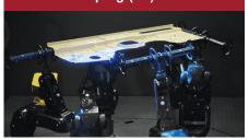
VC und PRAFS ermöglichen das Berechnen der flächigen und merkmalsbasierten Abweichung zwischen Soll- und Ist-Daten eines Bauteils ohne physikalischem Spannen oder bauteilspezifischer Messvorrichtung.
