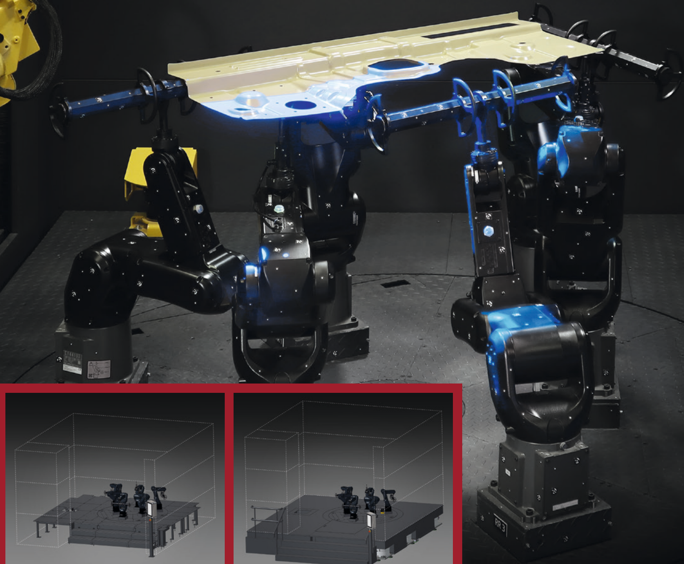
Für Messräume und an der Linie kann die Standard-PRAFS-Lösung (Abb. links) eingesetzt werden. Für Presswerke steht eine schwingungsentkoppelte PRAFS zur Verfügung (Abb. rechts).
